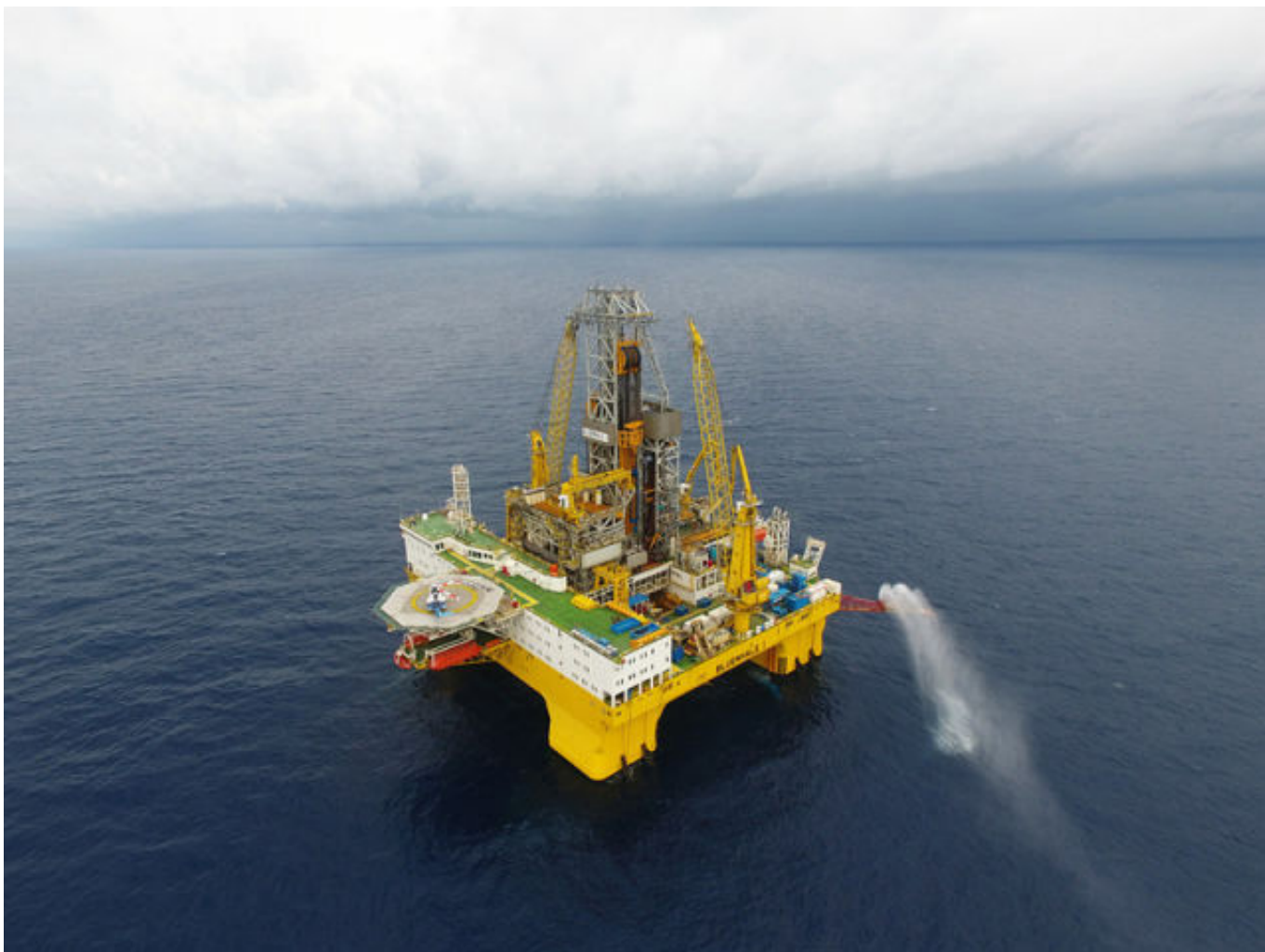
La Blue Whale 1, une plateforme de forage semi-submersible à deux tours en eaux ultra-profondes capable de forer à une profondeur maximale de 15 250 mètres, a été livrée en février 2017.
